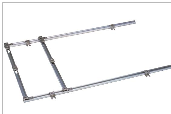
Los perfiles en C horizontales y verticales de la primera fila de bases se fijan entre si mediante la pieza de acoplamiento y las tuercas deslizantes. Estas piezas se fijan de la misma manera sobre el perfil horizontal.
