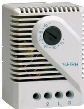
Este dispositivo controla el grado de humedad del aire de manera que cuando alcanza el valor crítico del 65% de humedad, este controlador se dispara. De esta forma, el sistema previene eficazmente contra los riesgos de formación de condensaciones y por lo tanto de corrosión.
